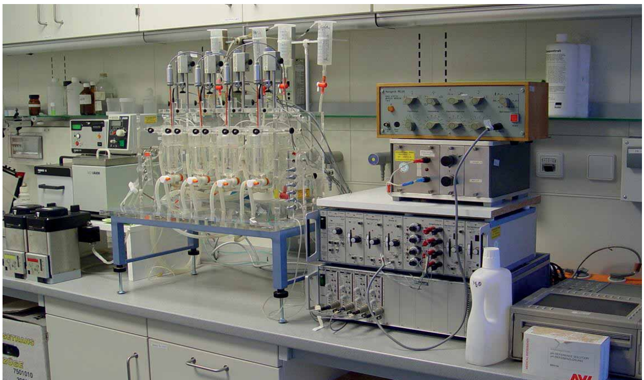
Abbildung 3: In vitro Kontraktur Testanlage. Im physiologischen Organbad werden die Muskelproben verschiedenen Triggersubstanzen ausgesetzt. Eine abnorme Reaktion (Kontraktur) zeigt die Anlage zur MH sicher an bzw. schließt sie aus.
